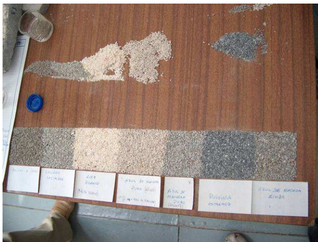
Fig. 25 – Seleção dos agregados para execução da marmorite
