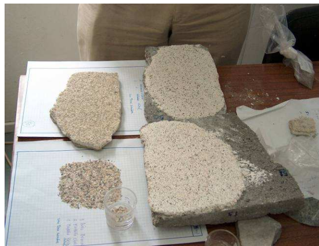
Fig. 26 – Amostras de marmorite com diferentes misturas de agregados
