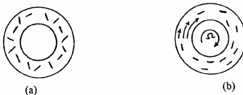
Figura 2. Orientação de partículas na forma de bastão em um fluxo viscoso de um viscosímetro de cilindros concêntricos; cilindro externo fixo. As setas representam o gradiente de velocidade no fluxo laminar. (a) em repouso: orientação aleatória. (b) após o cisalhamento.
