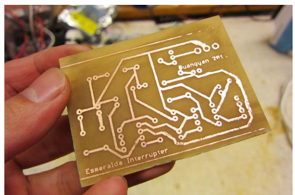
Fig. 06. - Placa de circuito plotado manualmente.
