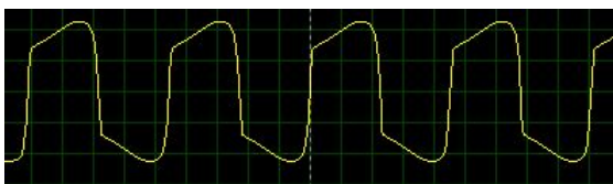
Figura 8. Simulação de Soft Clipping com parâmetros arbitrários 1
