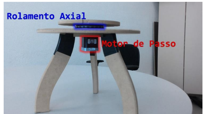
Fig. 11. Suporte, rolamento axial e motor de passo.
