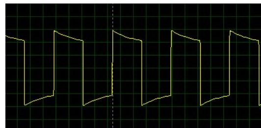
Figura 14. Simulação de Hard Clipping com parâmetros arbitrários 3
