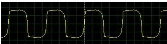
Figura 9. Simulação de Soft Clipping com parâmetros arbitrários 3
