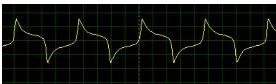
Figura 10. Simulação de Soft Clipping com parâmetros arbitrários 4
