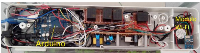
Figura 8 - Disposição dos componentes na estrutura de plástico
