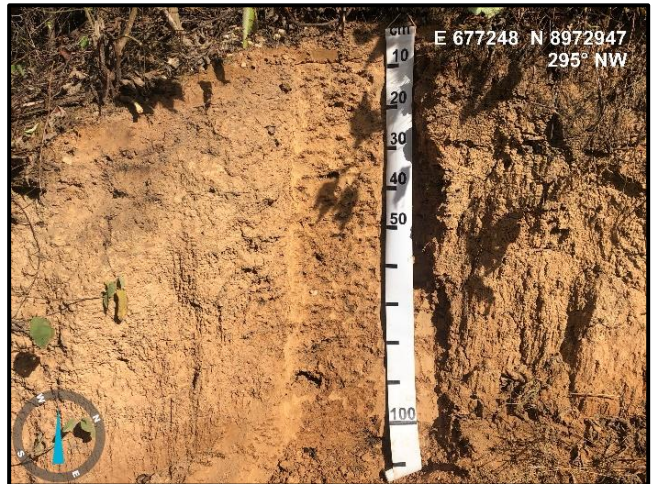
FOTO 6.1.3.4 – Argissolo Vermelho Amarelo identificado em corte na estrada de acesso à área de estudo.
