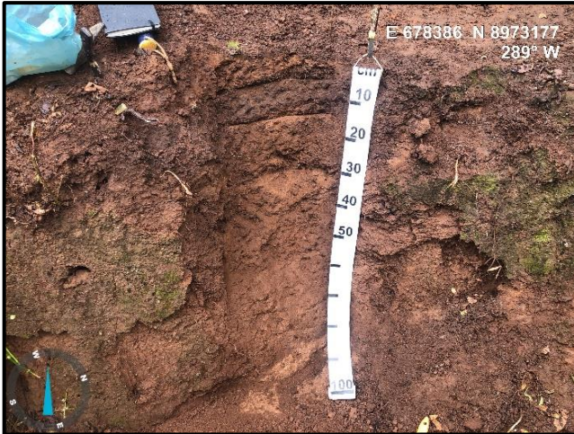
FOTO 6.1.3.1 – Perfil de solo da classe do Cambissolo Háplico, na área de estudo em antigo corte realizado para pesquisa mineral.
