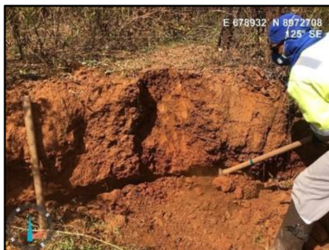
FOTO 6.1.3.12 – Retilização de perfil para descrição pedológica em corte de estrada onde ocorre o Argissolo Vermelho Amarelo.
