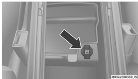
Center Console 12 Volt Power Outlet
